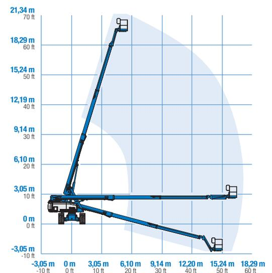
\* En el sistema métrico, altura de trabajo = altura de la plataforma + 2 m.
